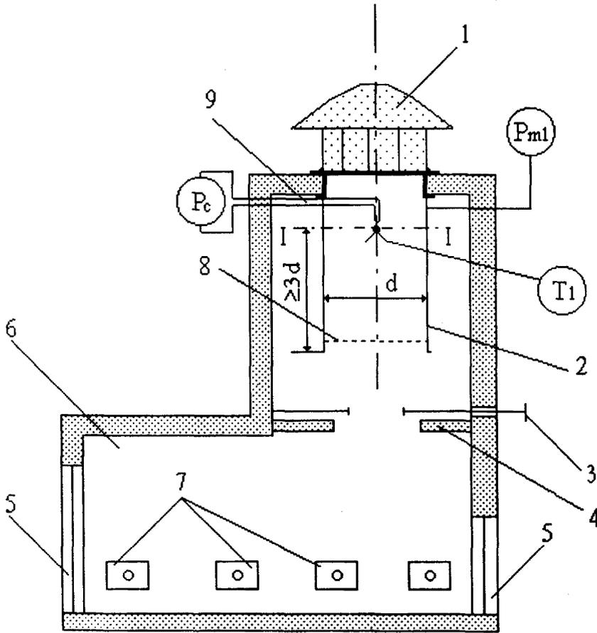
Рис. 2.1. Схема стенда для испытания крышных вентиляторов:
